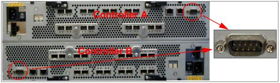
Figure 5-99 Serial port on DS5000 controller
